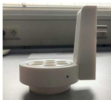
Fig. 12 Assembled TZ 3963 titration head
