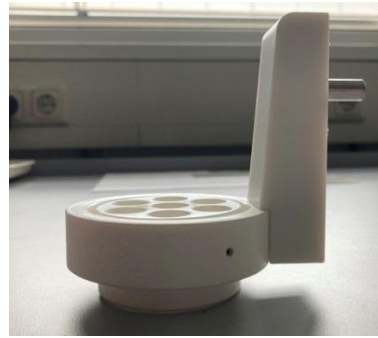
Abb. 12 Zusammengebauter Titrationskopf TZ 3963
