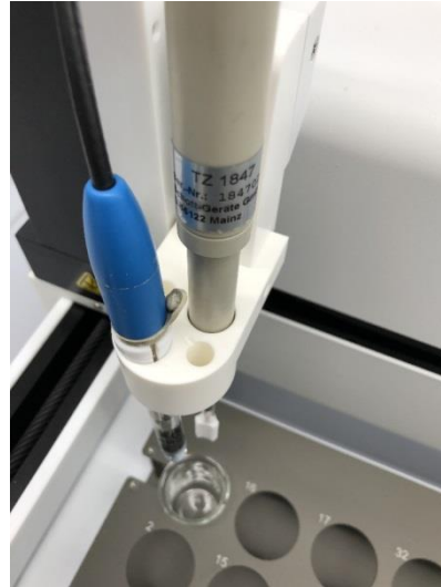
Abb. 18 und Abb. 19 Titrierkopf TZ 3974 mit eingesetzter LF Elektrode (links) bzw. pH Elektrode incl. Adapter TZ 1526 (rechts) sowie Stabrührer TZ 1847
