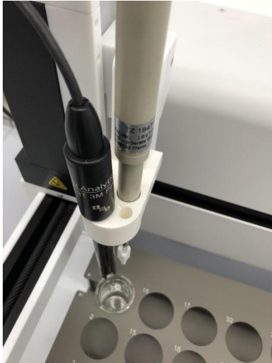
Abb. 18 und Abb. 19 Titrierkopf TZ 3974 mit eingesetzter LF Elektrode (links) bzw. pH Elektrode incl. Adapter TZ 1526 (rechts) sowie Stabrührer TZ 1847
