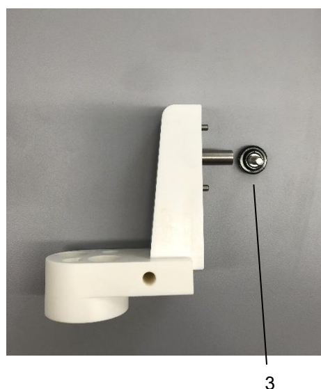
Fig. 14 Assembled TZ 3974 titration head
