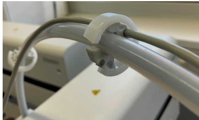
Abb. 17 An der Stromversorgung mittels Kabelführung befestigtes Kabel.
