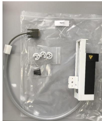
Abb. 3 Beutel 2 mit Titrationsturm und Schlauchklemmen
